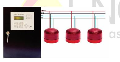
5.3. Configurar a central de alarme para em modo de endereçamento de dispositivos, de acordo o manual do equipamento (GF 125 ou GF-PRO 250), fechar um curtocircuito nos terminais de programação com o jumper. Os LED'S da sirene audiovisual irão piscar, indicando que ele está em modo de configuração. Após atribuir o endereço desejado, retire o jumper dos terminais de programação para que a sirene retorne ao estado inicial e saia do modo de configuração.
