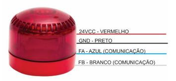
5.2. Os dispositivos podem ser instalados junto à central na modalidade "Classe B", com cabo blindado 4 vias (2x1,5mm² e 2x0,75mm²), como mostra a figura abaixo:
